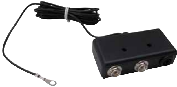
Skrzynka podłączeniowa do uziemienia ESD Pozycja nr 201890 Służy do podłączenia opasek uziemiających ESD, zatrzask 2x10mm, 2 złącza 4 mm. Do ochrony z rezystancją 1Mohm.
