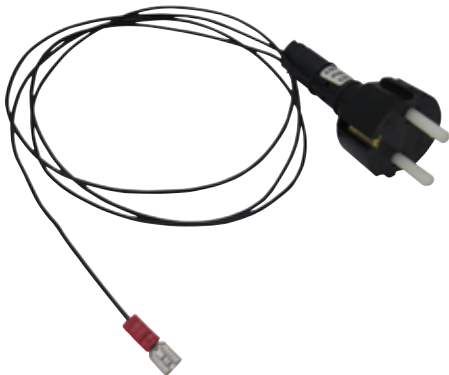
Połączenie do uziemienia ESD Pozycja nr 201893 Do połączenia z uziemieniem, blatów stanowisk montażowych ESD. Zaprojektowane dla ochrony ze wstawionym rezystorem 1Mohm. Połączenie na wsuwkę. Atest Semko.
